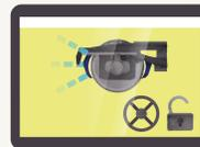
**2** Il collaboratore controlla via tablet che lo stato di sblocco dei freni ad aria compressa e di stanziamento sia segnalato da ogni carrozza.
