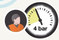
**3** Il collaboratore esegue una frenatura d'esercizio (ridurre la pressione dell'aria da 5 a 4 bar). Ora tutti i freni dovrebbero frenare.
