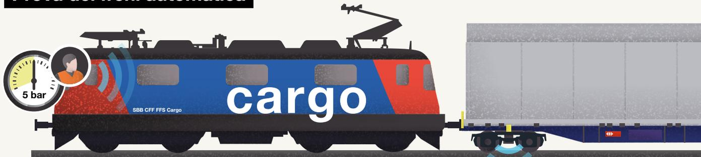
**1** Il collaboratore è in collegamento radio con l'elettronica di ogni carrozza via tablet per controllare la pressione nel cilindro del freno, la forza frenante (per i freni a ceppo) e il freno di stazionamento. Per prima cosa riempie la condotta principale della locomotiva con aria compressa (5 bar). Ora tutti i freni dovrebbero essere sbloccati.
