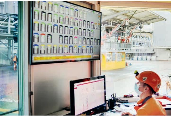
Eine Übersichtstafel zeigt den Füllstand und das Füllgut der verschiedenen Tanks im Tanklager an.
