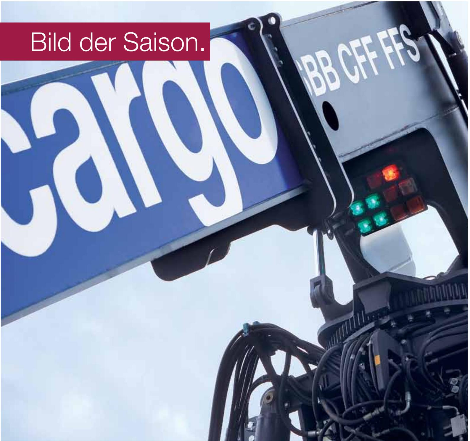
Starke Muskeln: Der Kombinierte Verkehr erfordert, dass die Transportbehälter mit den Gütern umgeladen werden – vom Lastwagen auf die Bahn und später wieder auf den Lastwagen. Um die Container, die bis zu 40 Tonnen wiegen, zu heben, braucht es schwere und starke Geräte. Guy Perrenoud fotografierte einen solchen Reachstacker im Terminal von SBB Cargo in Renens VD.
