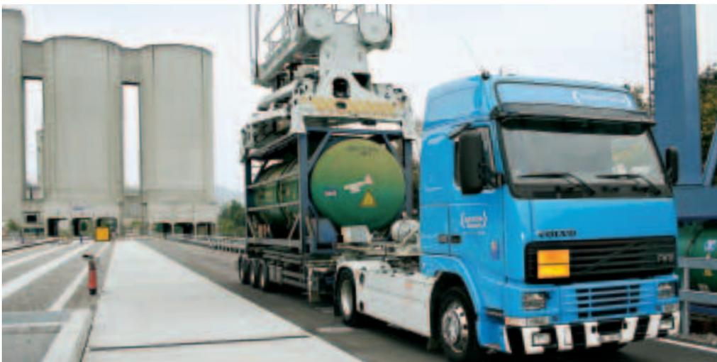
Von der Bahn auf Lastwagen: Ein Eisenchlorid-Tank wird umgeladen.
