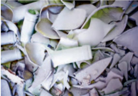
Milchig weisser Film: Auf dem Gelände herumfliegender Quarzsand beschichtet das Altglas, bevor es in den Recyclingprozess geschleust wird.
