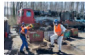
Die grossen Stücke werden mit dem Schneidbrenner von Hand in immer kleinere Teile zerlegt.
