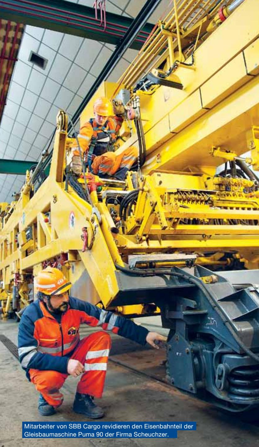
Mitarbeiter von SBB Cargo revidieren den Eisenbahnteil der Gleisbaumaschine Puma 90 der Firma Scheuchzer.
