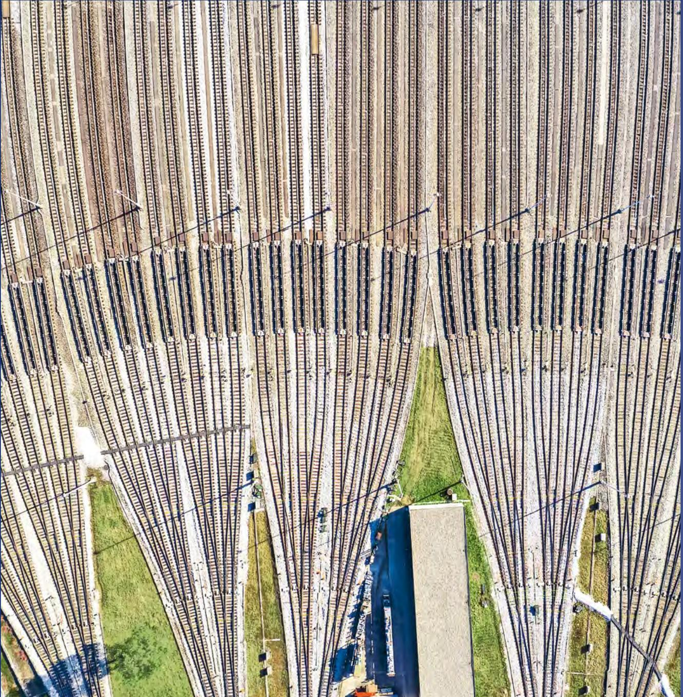
Eine Drohne hoch über den Gleisen des Rangierbahnhofs Limmattal ermöglichte dieses Foto. Es zeigt die Richtungsgleisstaffeln 3 bis 7. Jeder Waggon eines zu zerlegenden Güterzugs fährt den Ablaufberg hinunter auf das ihm zugewiesene Gleis (Fahrtrichtung vom unteren zum oberen Bildrand).
