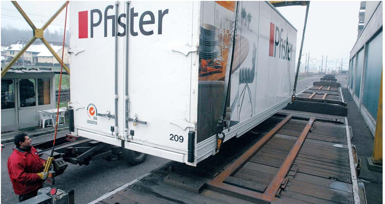
Einer von Pfisters Spezialcontainern wird in Suhr auf den Bahnwagen geladen.
