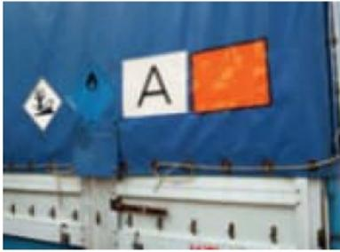
Sattelanhängen mit korrekter Abfall- und Gefahrgutkennzeichnung im Seeverkehr
