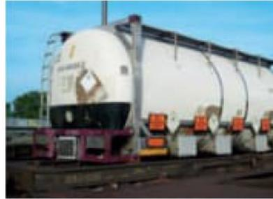
4-Kammer-Tankcontainer mit korrekter Gefahrgutkennzeichnung
