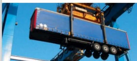
Sattelanhänger mit Planenaufbau in Curtainsiderausführung
