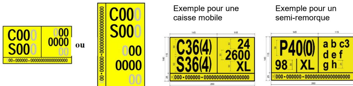
Chaque ILU est ainsi équipée des informations essentielles pour le transport: les codes de gabarit, de longueur, de largeur et de solidité pour les caisses mobiles; pour les semi-remorques, des informations complémentaires nécessaires au transbordement (hauteur du chariot, code de compatibilité pour les wagons-poche).
